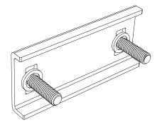
SLIDE NYLON RETAINER WASHERS AGAINST FLANGE CLAMP TO TIGHTLY SEAT SQUARE BOLT FEATURES IN SLOTS AS SHOWN.
